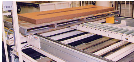
パネル加工工程における搬送ライン
