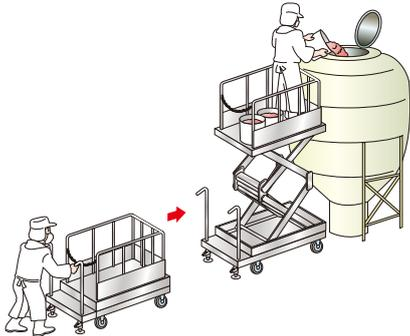
作業者と荷がシザーリフト上のにり、高所にある原材料の投入がラクに行うことができます。また、高所の作業も安全に行うことができます。本体が移動できるので、複数の場所で使用でき、使用しない時は別の場所に保管でき、床の清掃もできます
