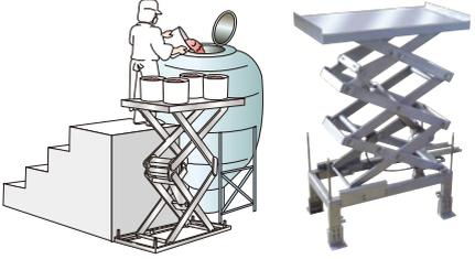
ブレンダー等の装置の投入口は高所にある場合が多く、シザーリフトを利用すれば重い原材料をラクに投入口まで運ぶことができます。作業者の労力軽減と安全作業の実現を提案いたします。
