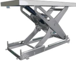
非売品 コンセプト展示でのご紹介です。電動式は、油圧を使用しないボールネジ式の昇降装置です。本体はステンレス製、シリンダと電装部品は防水仕様。本体に水をかけるデモンストレーションを行います。
