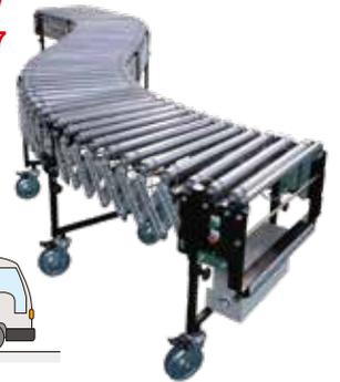
モータにより自動で荷物を搬送し、センサーにより一定間隔をあけて荷物を停止させ、貯めることが可能です。伸縮式の為コンベヤの機長を変えることが出来、カーブを形成することも可能です。
