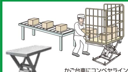
かご台車にコンベヤラインから流れてくる段ボールを積み込みます。かご台車を作業者が作業しやすい高さにすることが出来るので楽に作業が出来ます。
