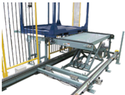
フォークリフトで運ばれた鉄パレットを シザーリフトで受けコンベヤラインまで 降ろし、搬送。
