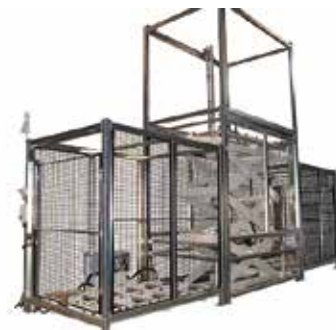
1～2階をコンベヤラインで搬送。 コンベヤ付シザーリフトで段差解消。 エレベータ対象外。
