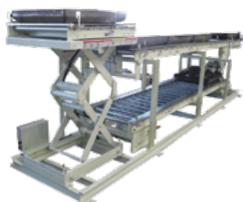
鋳物の冷却ラインとパレット返却ライン 2段のコンベヤの段差を搬送
