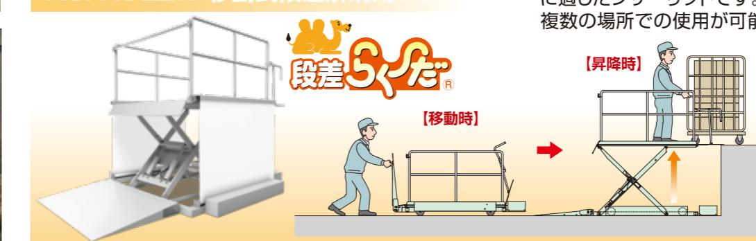
プラットホームなどの段差を解消する昇降装置で、カゴ台車の昇降に適したシザーリフトです。移動式なのでエレベーターにならず、複数の場所での使用が可能。トラックへのカゴ台車の積込みにもお使いいただいています。
