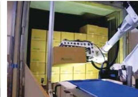
荷降ろし用ロボットと伸縮コンベヤ、さらに画像処理のシステムを搭載した「全自动デバンダ」です。異なるサイズの箱、積み付けパターンの違いも画像処理システムで認識してケースの荷降ろしを全自动で行います。
