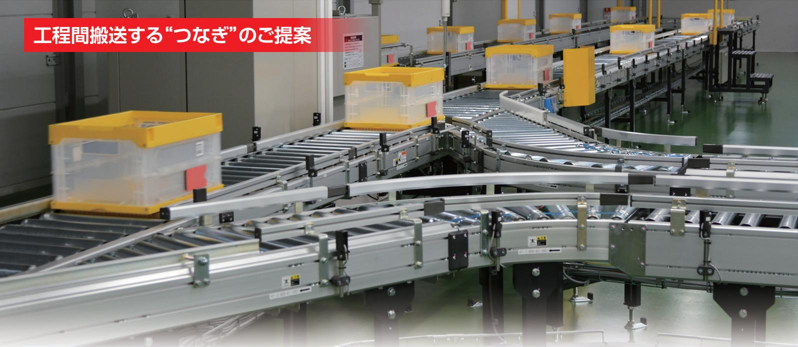
**特長** ケース搬送コンベヤとして最適な 50kg/m、100kg/mの2種類の許容搬送質量のコンベヤがあります。
