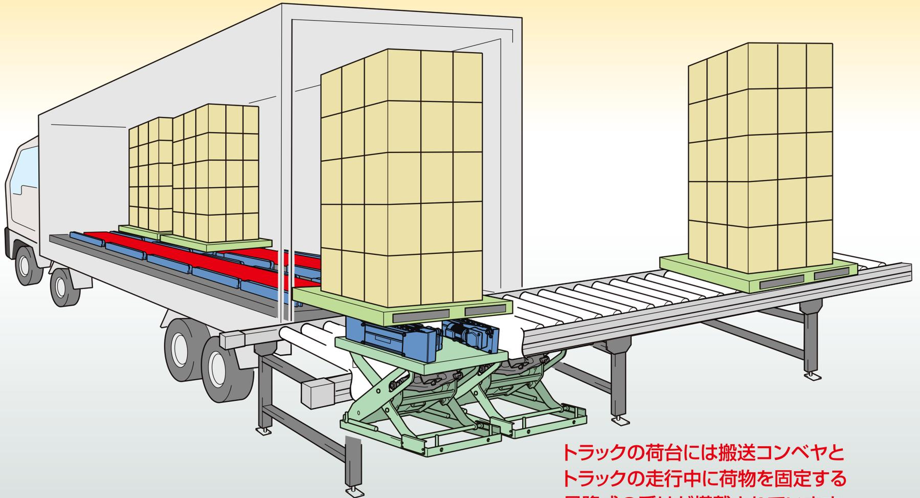
トラックの荷台には搬送コンベヤとトラックの走行中に荷物を固定する昇降式の受けが搭載されています。トラック内部の装置の高さは約200mmです。
