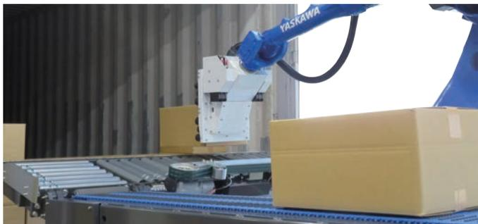
ロボットハンドは当社の独自開発。吸着した荷物に荷受コンベヤが同調し荷降ろし時間を短縮します。
