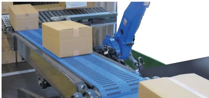
移動式樹脂製ベルトコンベヤも独自開発。ロボット台車に追従(15m伸縮)し荷物をコンテナの奥から外へ運び出します。
