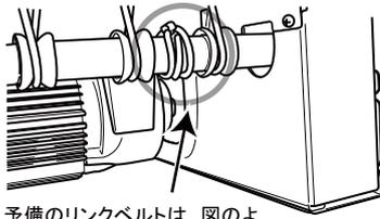
予備のリンクベルトは、図のようにインシュロックでドライブシャフトに固定されています。
