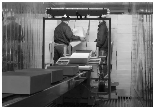
写真.3 リーファーコンテナ用デバンダ
