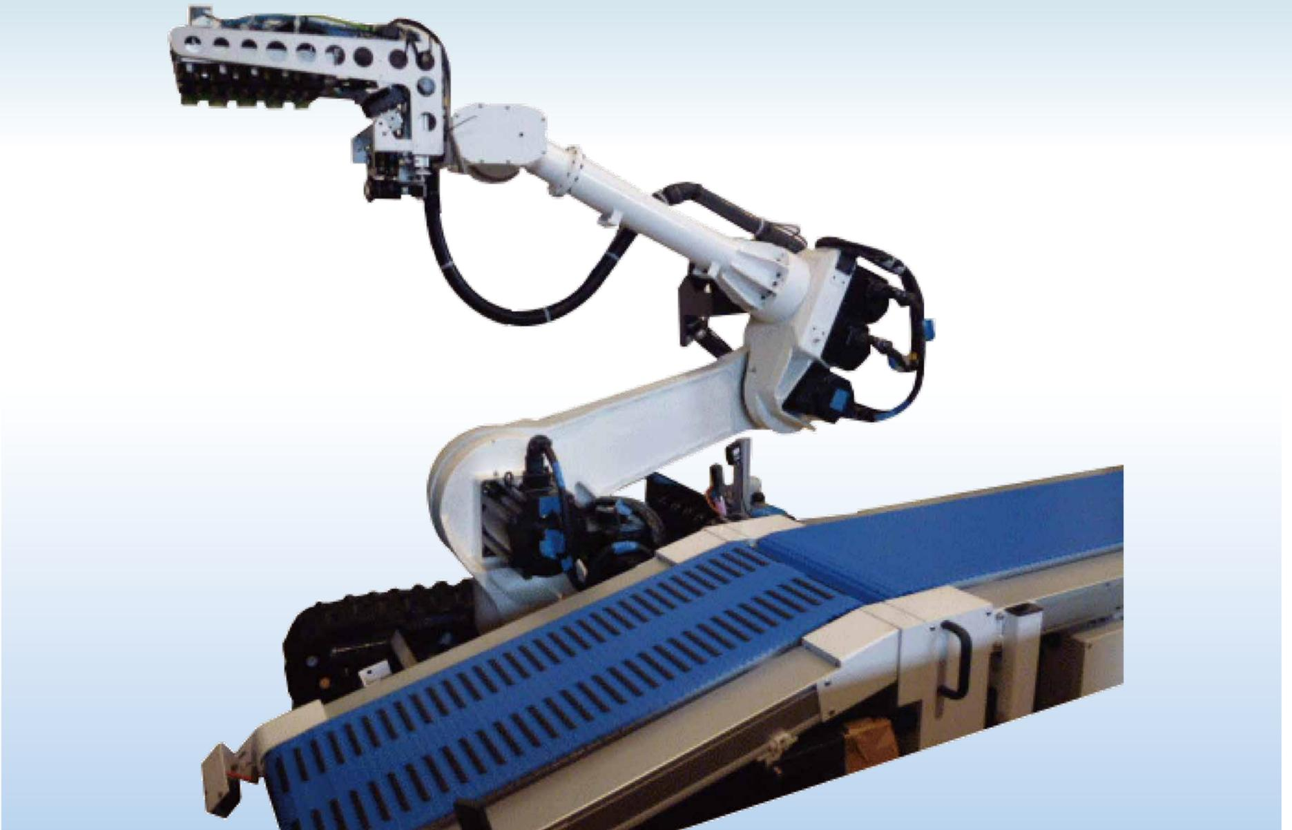
**ロボットと伸縮コンベヤ**、進入・後退の走行機能を持ち、さらに画像処理を搭載した「全自動荷降ろしシステム」です。
