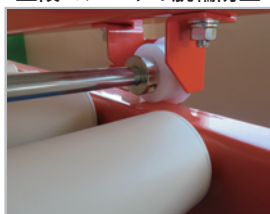
フランジ付ホール 上段コンベヤの脱輪防止
